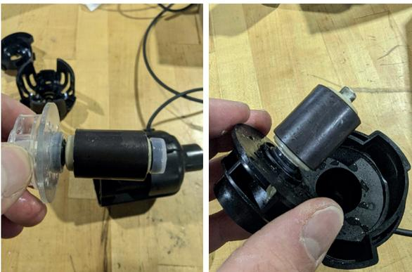
**Hinweise:** Wenn das Lager sich löst und mit dem Laufrad aus dem Motor kommt, kann es mit den Fingern oder einem Schraubenzieher leicht wieder eingebaut werden. Das Lager hat eine glatte Seite und eine Seite mit zwei Kerben. Achten Sie immer darauf, dass die glatte Seite in die Gummidichtung geht und die gekerbte Seite zum Laufrad zeigt.
