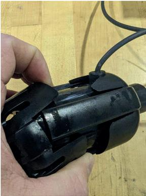
**Entfernen des Impellers:** Sobald die untere Abdeckung entfernt ist, wird die Impellerabdeckung sichtbar. Fassen Sie den Deckel am Innendurchmesser an und ziehen Sie ihn vorsichtig aus der Pumpe heraus. Möglicherweise müssen Sie ihn herausrucken, da er fest sitzt. Das Laufrad ist nun sichtbar und kann leicht entfernt werden.
