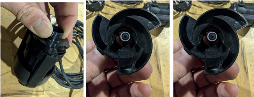
Durch diese vollständige Demontage wird sichergestellt, dass alle Teile des Motors ordnungsgemäß in eine Lösung aus 50/50 heißem Wasser und Essig oder in eine Lösung aus Zitronensäure getaucht werden können.
