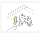
Die Schranktüren können mit den Schrauben wie abgebildet geringfügig in der Höhe verstellt werden. Lösen Sie die Schrauben an der Ober- und Unterseite der beiden Scharniere und die Tür fällt nach unten. Heben Sie die Tür in ihre Position und ziehen Sie die Schrauben fest.
